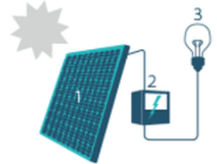
1. Zonnepaneel | 2. Omvormer | 3. Elektrische toestellen
